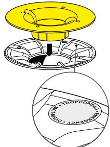
Använd skyddslocket ända tills monteringen är klar. Det kan användas för tillfällig avvattnning genom att avlägsna klisterlappen som täcker hålen. Om brunnen används som bräddavlopp märks den med bifogat klistermärke.
